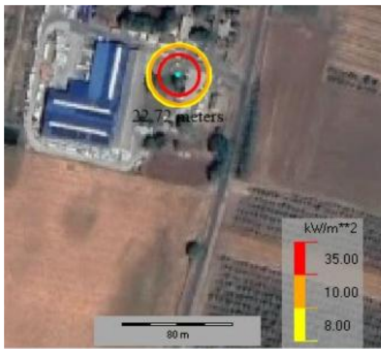
PB_1 megvalósulásának következménye tócsatűz esetén
