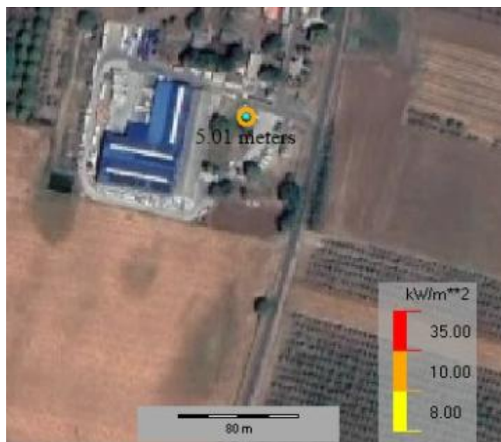
PB_2 megvalósulásának következménye tócsatűz esetén
